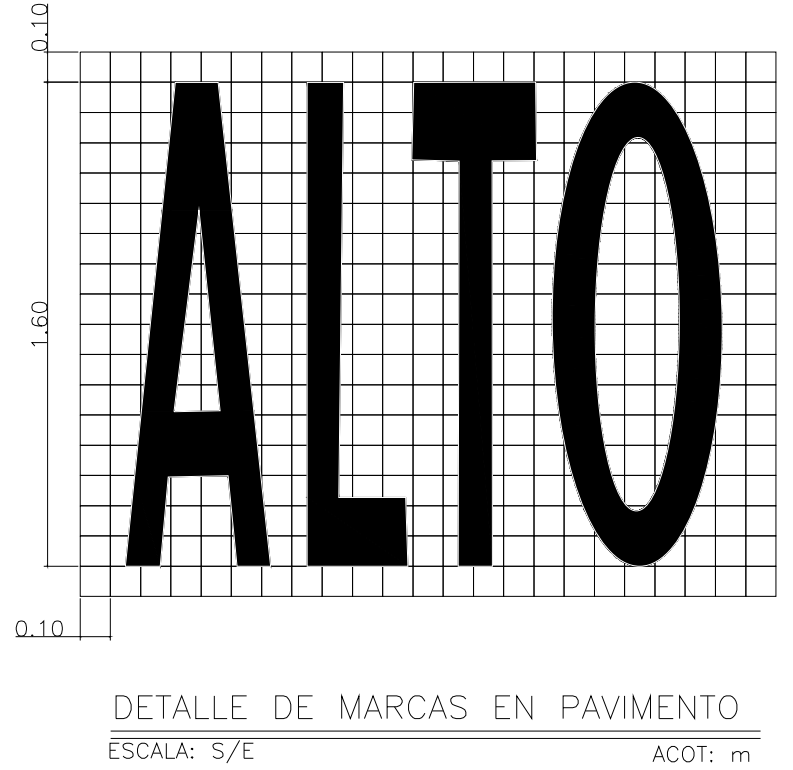
DETALLE DE MARCAS EN PAVIMENTO ESCALA: S/E ACOT: m
